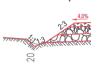
Sectiune tip sant cu sectiune neamenajata
